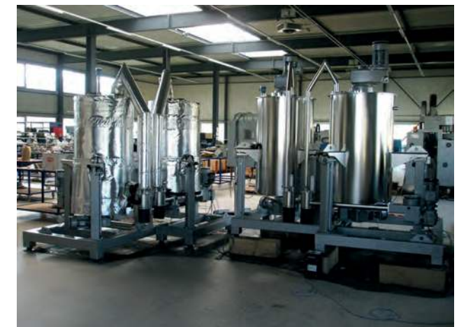
Batterieproduktion Dosiergeräte komplett isoliert
